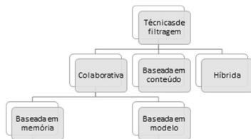
Figura 2 As quatro principais técnicas de filtragem
